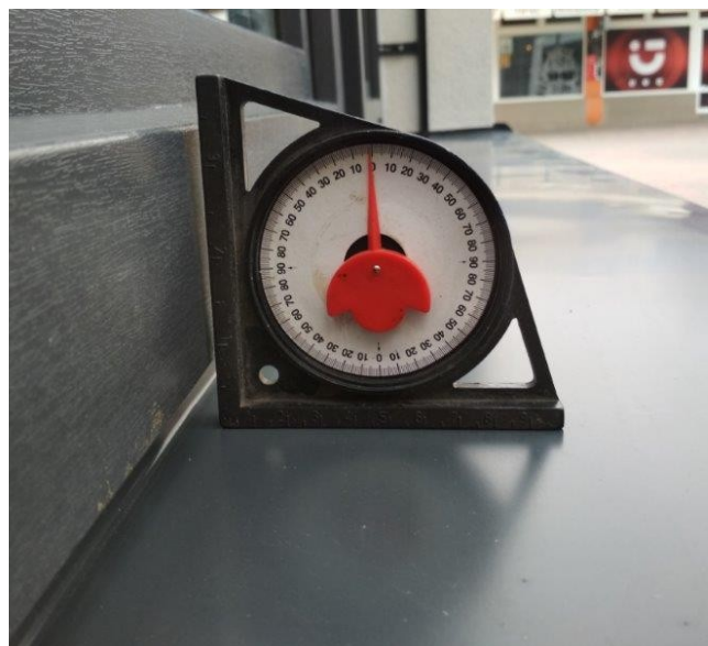
obr. /25/ Nedostatečný spád oplechování parapetů
